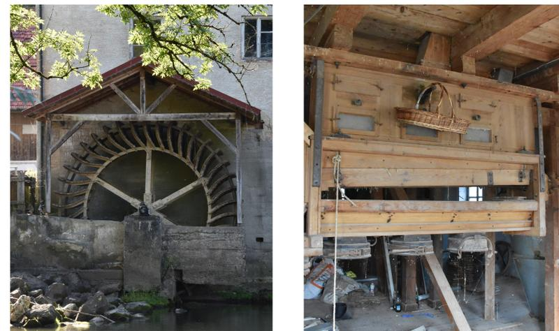
Unterschlächtiges Mühlrad (links) und Abfüllwerk (rechts) der Mühle bei Wollbach
